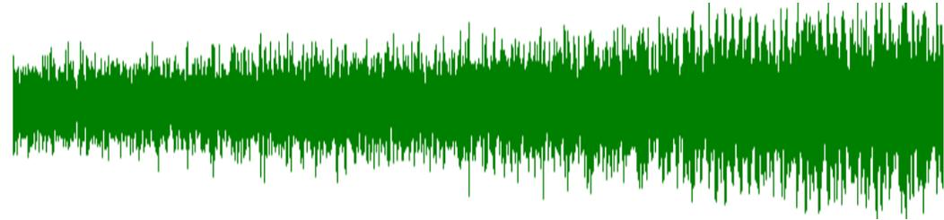
Запись временного сигнала на корпусе шпинделя станка с неустойчивым процессом резания в процессе обработки канавки с подачей 0.1 мм/об
