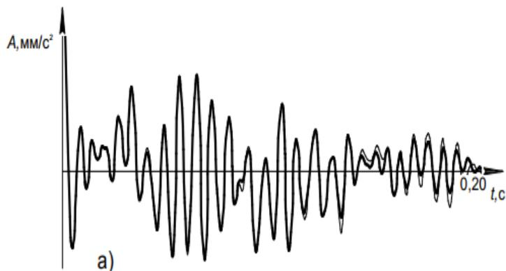
Результаты аппроксимации сигнала, снятого на станине токарного станка в сборе
